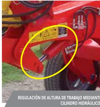
REGULACIÓN DE ALTURA DE TRABAJO MEDIANTE CILINDRO HIDRÁULICO.
